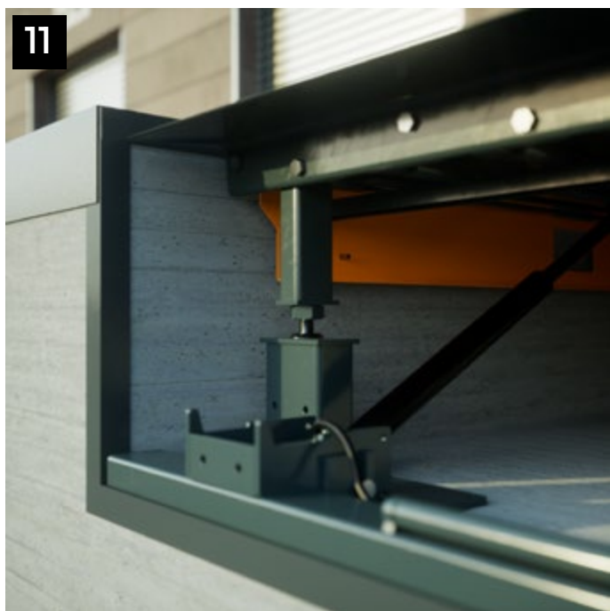
Richiudere l'unghia e farla appoggiare nella propria sede / Close the lip and let it rest in its designated seat.
