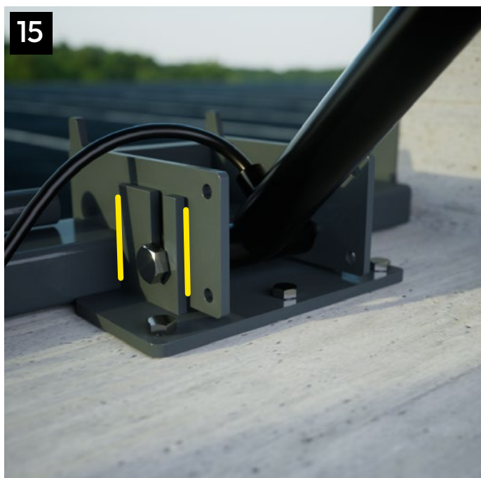
15 Saldare da entrambi i lati di ogni pistone la piastra di regolazione come indicato in figura / Weld the adjustment plate on both sides of each piston, as shown in the figure.
