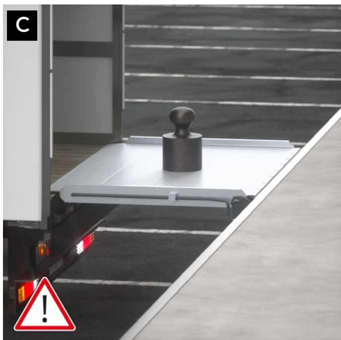
Verificare il carico massimo, non sovraccaricare / Check max weight allowed, do not overload
