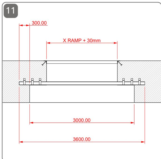
Il vano sponda dovrà essere largo 3000mm mentre le travi 3600mm / The side compartment must be 3000mm wide and the beams 3600mm
