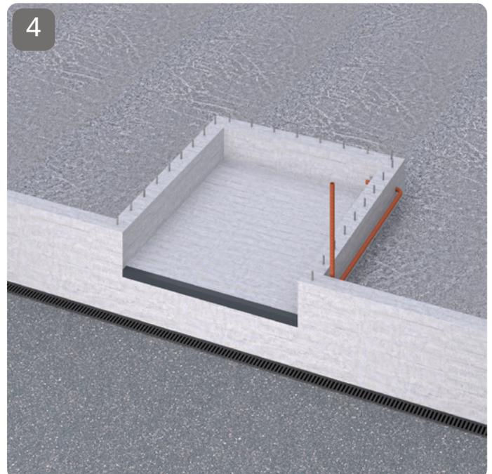
In fase di realizzazione delle pareti della fossa, predisporre il corrugato passacavi e tondini Ø12mm / When constructing the walls of the pit, prepare the corrugated cable duct and Ø12mm iron bars
