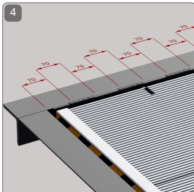
Fissare la rampa all'angolare posteriore con dei cordoli di saldatura lunghi e distanti tra loro 70mm / Secure the ramp to the rear corner with long and apart 70mm welding rods
