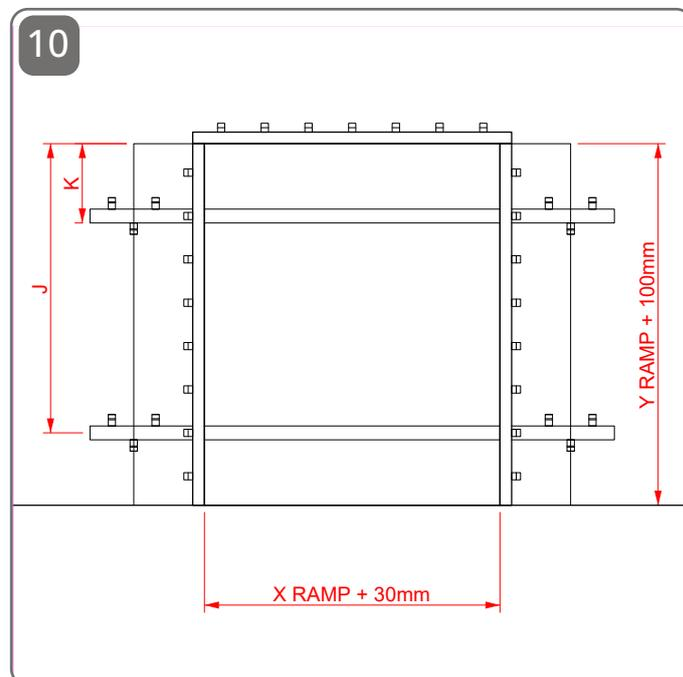
Predisporre la fossa sommando alla misura della rampa 30mm in larghezza e 100mm in profondità / Prepare the pit by adding 30mm in width and 100mm in depth to the measurement of the ramp
