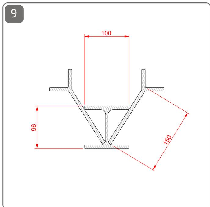
Procurarsi travi HEA100 96x100mm con zanche su ambo i lati posizionate alla misura in cui la trave sarà annegata nel cemento / Procure beams HEA100 96x100mm with tangs on both sides positioned at the extent where the beam will be embedded in the concrete
