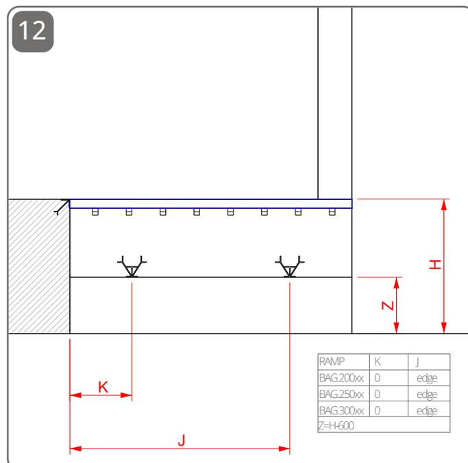
Posizionare le travi in profondità seguendo le specifiche / Place the beams deep according to the specifications
