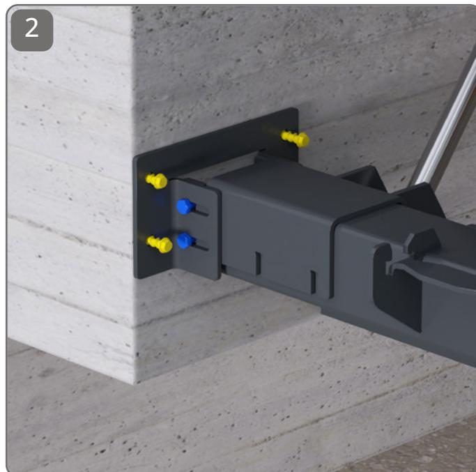
Fissare la trave anteriore a muro mediante tassellatura della staffa di posizionamento (bulloni in giallo). Poi stringere i bulloni di regolazione in blu / Fix the front beam to the wall by screwing the positioning bracket (yellow bolts). Then tighten the (blue) adjustment bolts
