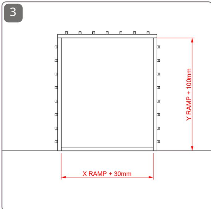
L'angolare di ferro frontale opzionale va inserito nel cemento durante la preparazione della fossa / The optional front iron angular is inserted into the concrete during pit preparation
