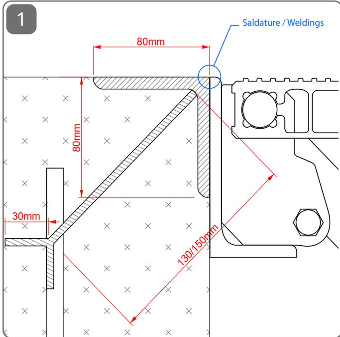
Procurarsi dei profili angolari in ferro SP8mm da 80x80mm con zanche lunghe circa 140mm. Assicurarsi di saldare la cerniera esattamente a livello dell'angolare senza interruzioni / Obtain some 80x80mm SP 8 mm iron angular profiles with approximately 140mm tangs. Make sure to weld the backhinge exactly at the same level as the angle without gaps
